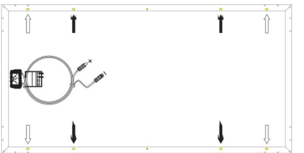
↑ Fori di montaggio per un'installazione normale
