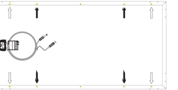
↑ Fori di montaggio per un'installazione normale
