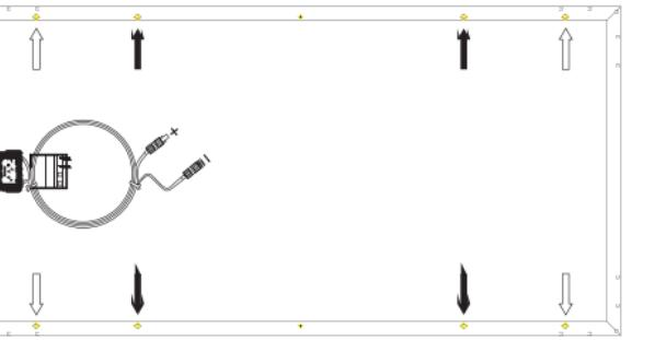
↑ Montagebohrungen für eine normale Installation
