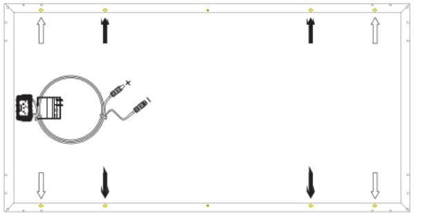
↑ Montagebohrungen für eine normale Installation
