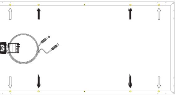
↑ Orifices de fixation pour une installation normale
