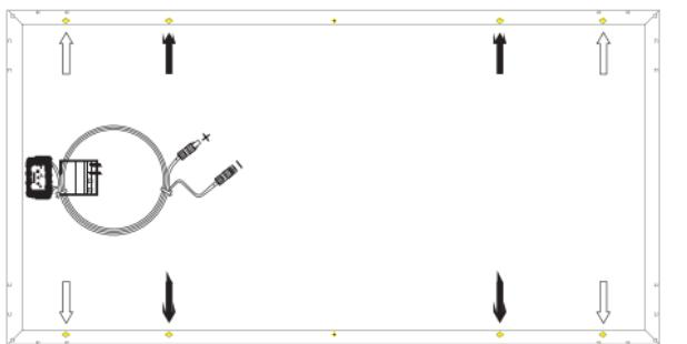
↑ Orificios de montaje para una instalación común
