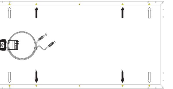
↑ Orificios de montaje para una instalación común
