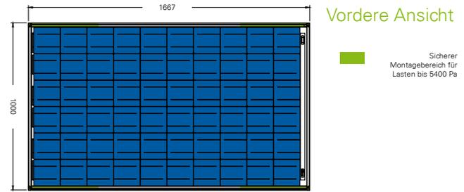
Sicherer Montagebereich für Lasten bis 5400 Pa
